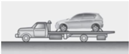
Рекомендуется использование колесных тележек или автомобиля с безбортовой платформой. Информацию по буксировке прицепа см. в разделе 5 «Буксировка прицепа».
