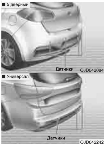
Система задней парковки предназначена для помощи водителю при движении автомобиля задним ходом. Система выдает звуковое предупреждение, если на расстоянии 120 см (47 дюймов) от задней части автомобиля обнаружен какой-нибудь объект. Данная система является исключительно вспомогательной.
