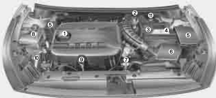
1. Крышка маслозаливной горловины двигателя
