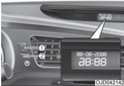
Чтобы сменить дату, время или единицу измерения температуры ( $^{\circ}\text{C} \leftrightarrow ^{\circ}\text{F}$ ), нажать кнопку SET (2) дольше 1 секунды.
