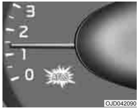
Этот индикатор загорается в случае неисправности системы AFLS.
