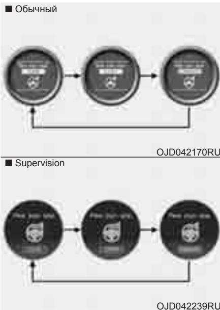
После нажатия кнопки режима рулевого управления выбранный режим отображается на ЖК-дисплее.
