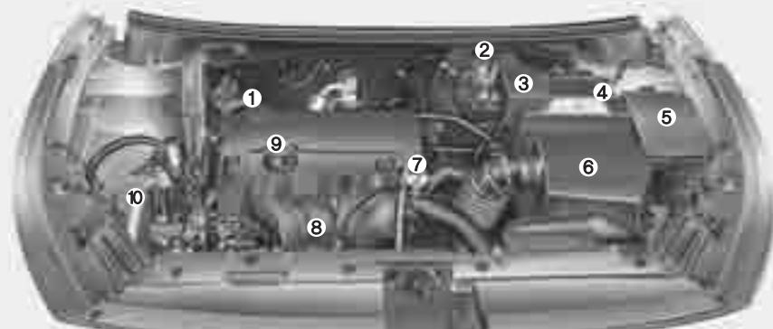
1. Крышка маслозаливной горловины двигателя
