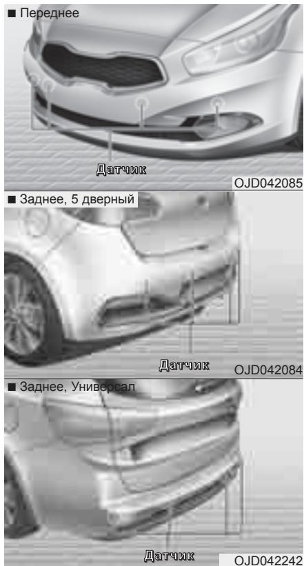
Система помощи при парковке подает звуковые сигналы или отображает на комбинации приборов зону нахождения объекта при его обнаружении на расстоянии 60 см (тип А) или 100 см (тип В) спереди и 120 см сзади автомобиля.
