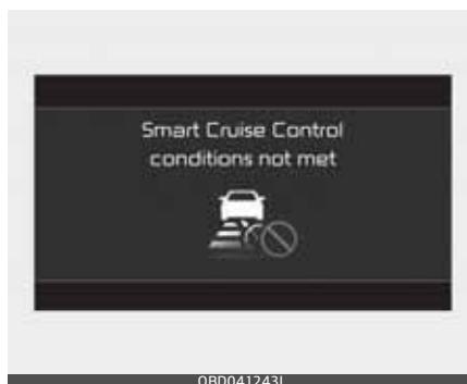
Ja tiek nospiesta vadīšanas palīgsistēmas poga, +, - vai || ⌂ slēdzis, kamēr funkcijas darbības nosacījumi nav izpildīti, mērinstrumentu blokā parādīsies "Smart Cruise Control conditions not met" (Nav izpildīti viedās kruīza kontroles nosacījumi), un atskanēs akustisks brīdinājums.
