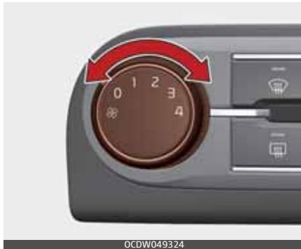
Ventilatora ātruma kontroles ripa ņauj kontrolēt ventilatora ātrumu un plūsmu ventilācijas sistēmā.
