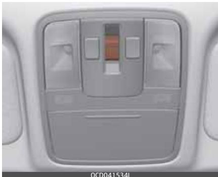
Jumta lūku var darbināt, tikai ja aizdedzes slēdzis vai poga ENGINE START/STOP ir ON vai START pozīcijā.
