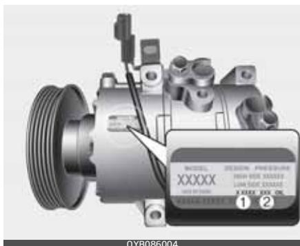
Kompresora uzlīme informē par automobilī izmantotā kompresora veidu, tā modeli, piegādes daļas numuru, izgatavošanas numuru, dzesēšanas līdzekli (1) un aukstumači (2).
