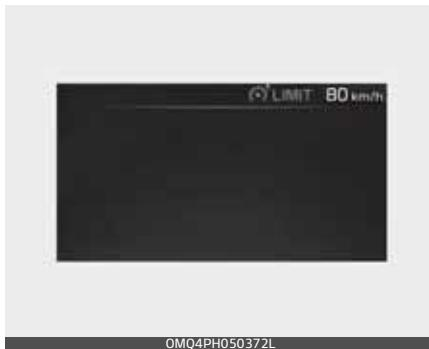
3. Iestatītais ātruma ierobežojums tiks parādīts mērinstrumentu blokā. Ja vēlaties braukt pāri ieprogrammētajam ātruma ierobežojumam, spiežiet akseleratora pedāli pāri
