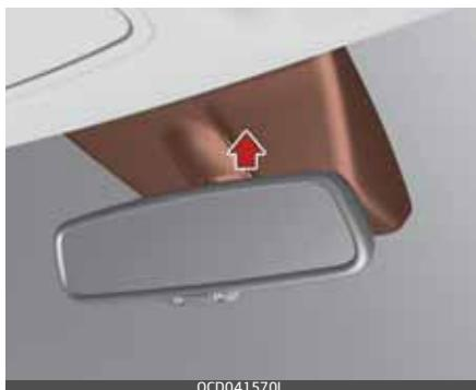
Automātiskā aizsvīduma notīrišana samazina iespēju vējstiklam aizsvīst no iekšpuses automātiski konstatējot mitrumu uz vējstikla iekšējās virsmas un gaisa plūsma virzienā uz vējstiklu pastiprināsies.
