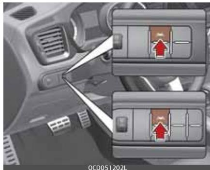
Ja aizdedzes slēdzis vai poga ENGINE START/STOP ir ieslēgtā pozīcijā, nospiediet un turiet joslas drošības pogu, kas atrodas mērinstrumentu panelī, lai ieslēgtu turēšanās joslā
