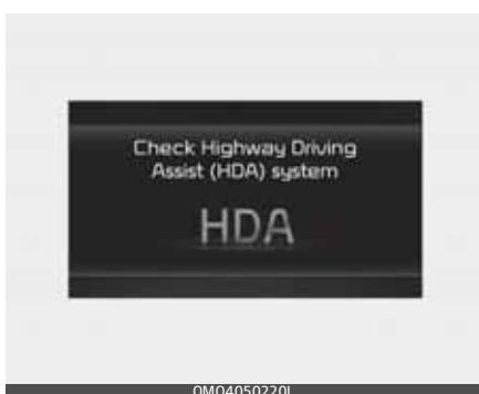
Ja braukšanas pa autostrādi palīgsistēma nedarbojas pareizi, parādīsies brīdinājuma pazīnojums "Check Highway Driving Assist (HDA) system" (Pārbaudiet braukšanas pa autostrādi palīgsistēmu (HDA)), un mērinstrumentu panelī iedegsies (⚠) brīdinājuma lampiņa.
