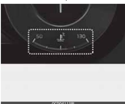
Tas rāda motora dzesēšanas šķidruma temperatūru, kad ir ieslēgts aizdedzes slēdzis vai ENGINE START/STOP poga.
