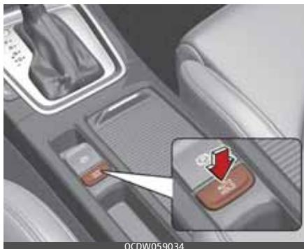
1. Kad vadītāja durvis, motorpārsegs un bagāžas nodalījuma durvis ir aizvērtas, piesprādzējet vadītāja drošības jostu vai nospiediet bremžu pedāli, tad nospiediet pogu *Auto Hold* (Automātiskā turēšana). Balts indikators AUTO HOLD izgaismosies un sistēmas būs gaidīšanas stāvoklī.
