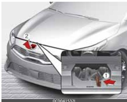
2. Aizejiet pie automobiļa priekšgala, nedaudz paceliet motorpārsegū un atvienojiet otro fiksatoru (1) motorpārsega centrālajā daļā un paceliet motorpārsegū (2).
