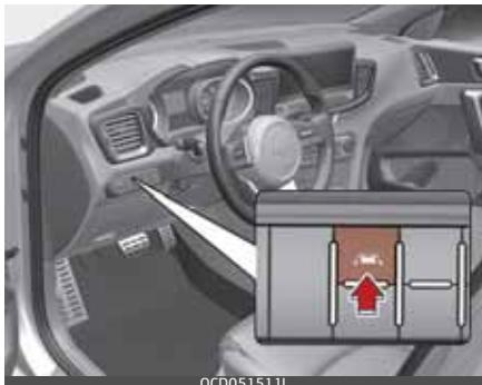
Lai aktivizētu/deaktivizētu turēšanās joslā palīgsistēmu, kad aizdedzes slēdzis vai poga ENGINE START/STOP ir ieslēgta, turēšanās joslā palīgsistēma ieslēdzas automātiski. Indikators (🚘) mērinstrumentu blokā no sākuma iedegas baltā krāsā. Ja nospiežat turēšanās joslā palīgsistēmas pogu, kas atrodas mērinstrumentu panelī pa kreisi no vadītāja apakšā, turēšanās joslā palīgsistēma izslēgsies, un indikators mērinstrumentu panelī nodzīsīs.
