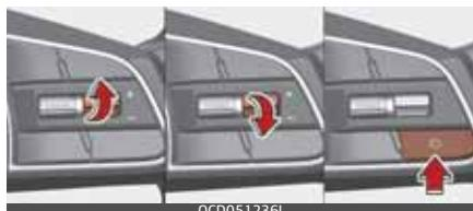
Ja nospiežat ||○ pogu, automobiļa ātrums atgriezīsies pie ieprogrammētā ātruma. Automobiļa ātrumam jābūt virs 30 km/h, lai funkcija varētu atjanoties.
