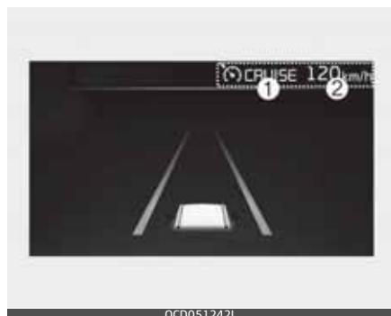
Jūs varat redzēt viedās kruīza kontroles darbības statusu mērinstrumentu bloka vadīšanas palīgsistēmu skatā. Skatiet "Mērinstrumentu bloks" 4-69. lpp.
