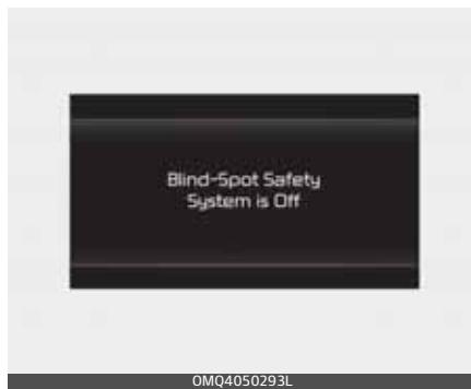
Ja motors tiek atkal iedarbināts ar izslēgtu funkciju, mērinstrumentu blokā parādīsies paziņojums "Blind-Spot Safety System is Off" (Aklā punkta drošības sistēma ir izslēgta).
