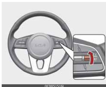
Ja nospiežat RES+ slēdzi uz augšu, iestatītais ātrums atgriežies pie ieprogrammētā ātruma. Automobiļa ātrumam jābūt virs 30 km/h, lai funkcija varētu atjanoties.
