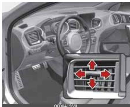
Atveres var atvērt vai aizvērt atsevišķi ar pagriežamo slēdzi. Lai aizvērtu gaisa sprauslu, pagrieziet to pa kreisi līdz galam.
