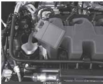
Pēc motorpārsega noņemšanas uzpildiet motorellu.
