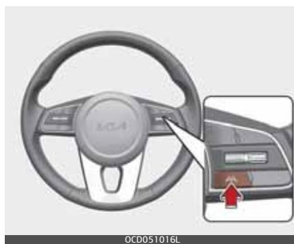
Ja aizdedzēs slēdzis vai poga ENGINE START/STOP ir ieslēgtā pozīcijā, nospiediet joslas vadīšanas palīgsistēmu pogu, kas atrodas uz stūres, lai ieslēgtu sekošanas joslai palīgsistēmu. Mērinstrumentu blokā iedegsies baltais vai zaļais (⌚) indikators.
