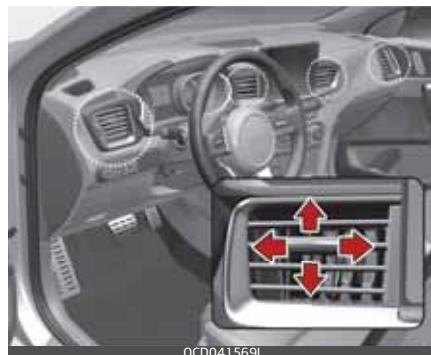
Atveres var atvērt vai aizvērt atsevišķi ar pagriežamo slēdzi. Lai aizvērtu gaisa sprauslu, pagrieziet to pa kreisi līdz galam. Lai aizvērtu gaisa sprauslu, pagrieziet to pa kreisi līdz galam.
