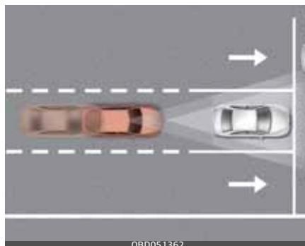
Izvairīšanās no frontālas sadursmes palīgsistēma ir paredzēta, lai palīdzētu konstatēt un uzraudzīt priekšā braucošo automobili vai palīdzētu konstatēt gājēju vai velosipēdistu uz braucamās daļas, brīdinot vadītāju ar brīdinājuma paziņojumu un akustisko brīdinājumu, ka ir iespējama sadursme, un ieslēdz ārkārtas bremzēšanu.
