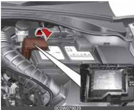
Drošinātāju bloku pārsegu iekšpusē atrodas uzlīme, kur var atrast drošinātāju / releju nosaukumus un kapacitāti.
