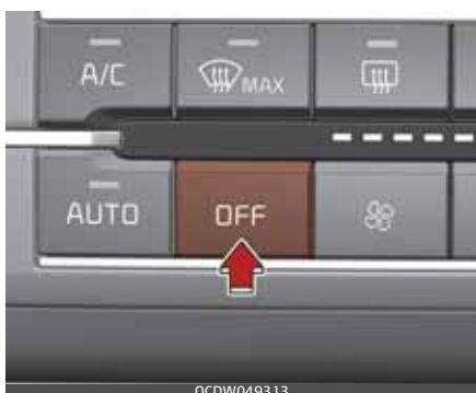
Nospiediet pogu OFF, lai izslēgtu klimata kontroles sistēmu. Tomēr, vēl aizvien var izmantot režimu un gaisa ieplūdes taustiņus, kamēr aizdedzes slēdzis ir stāvoklī ON.
